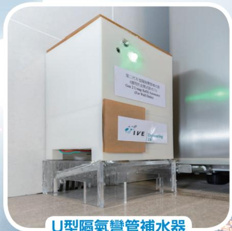
U型隔氣彎管補水器
