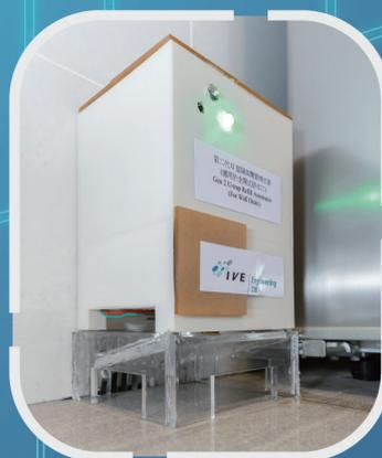
U型隔氣彎管補水器
